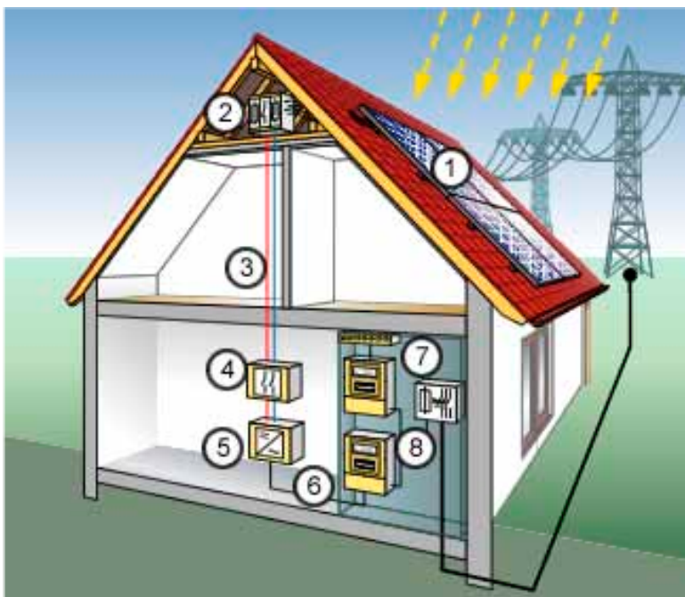
Bild 1: prinzipieller Aufbau einer PV-Anlage (Quelle: DGS)
