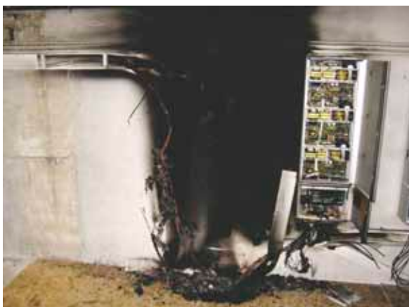
Bild 23: Brandschaden durch lose Klemmstelle an einem PV-Verteiler, aufgrund eines falsch eingelegten Gewindeplättchens, siehe rechts (Quelle Markus Scholand)
